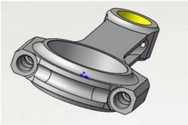
Ogni asta è trattata termicamente a più stadi, [100% lavorata](#) poi sparata contro lo stress, per alleviare il metallo. Le aste sono dotate di manicotti di allineamento dei tappi di precisione per posizionare in modo positivo ciascun cappuccio dell'asta, boccole in bronzo siliconato per i modelli con perno flottante e sono disponibili nei modelli stroker che consentono una maggiore distanza tra camma e biella per combinazioni di corsa ampia.
