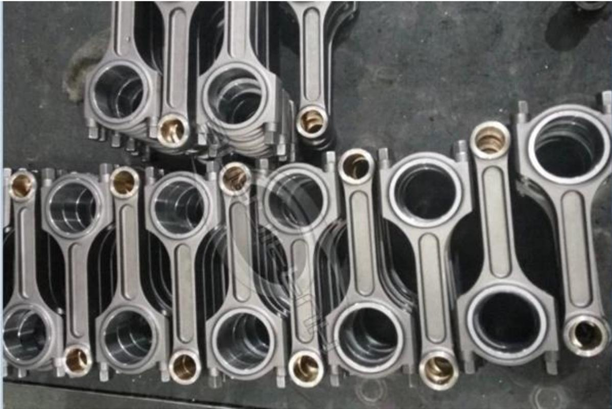
3). Trattato termicamente in HRC 34-38 e lucidato e infine pallinato per elevata resistenza a fatica.
