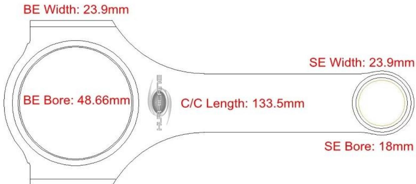
Citroen / Peugeot 106 GTi / S16 1.6L TU5J4 Le barre di collegamento H-Beam da 133,5 mm sono prodotte in acciaio ad alta resistenza 4340 e sono progettate per alte prestazioni e durata estrema. Vengono sparati per alleviare lo stress dal materiale e il trattamento termico multistadio per aumentare la rigidità. Le strette tolleranze nel processo di produzione assicurano un montaggio perfetto ottimizzando al contempo i giochi petroliferi. Piegar e torcere è strettamente controllato.
