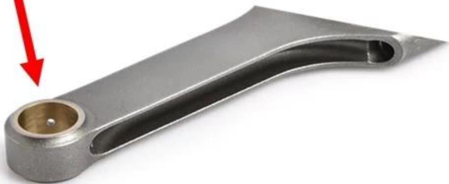
Un foro d'olio praticato nella parte superiore dell'estremità piccola per una lubrificazione sufficiente per il pistone, per aumentare la durata della fatica del pistone.
