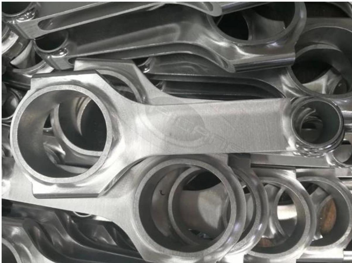
Ogni asta è dotata di boccia bronzata di alta qualità adatta per lo spinotto del pistone flottante e perni posizionati sul cappuccio dello stelo per ottenere un assemblaggio accurato. Inoltre, tutte le estremità piccole e grandi sono levigate dalla levigatrice SUNNEN per soddisfare elevati standard di tolleranza, quindi sono una buona scelta per i vostri motori ad alte prestazioni.
