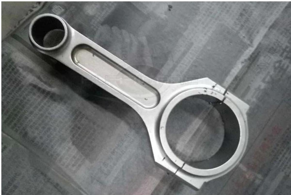
Inoltre, per bielle da 7.100 "vengono inserite boccole in bronzo ad alta resistenza per pistone flottante, tasselli di alta qualità installati su ogni asta per una perfetta aderenza e un accurato rimontaggio.
