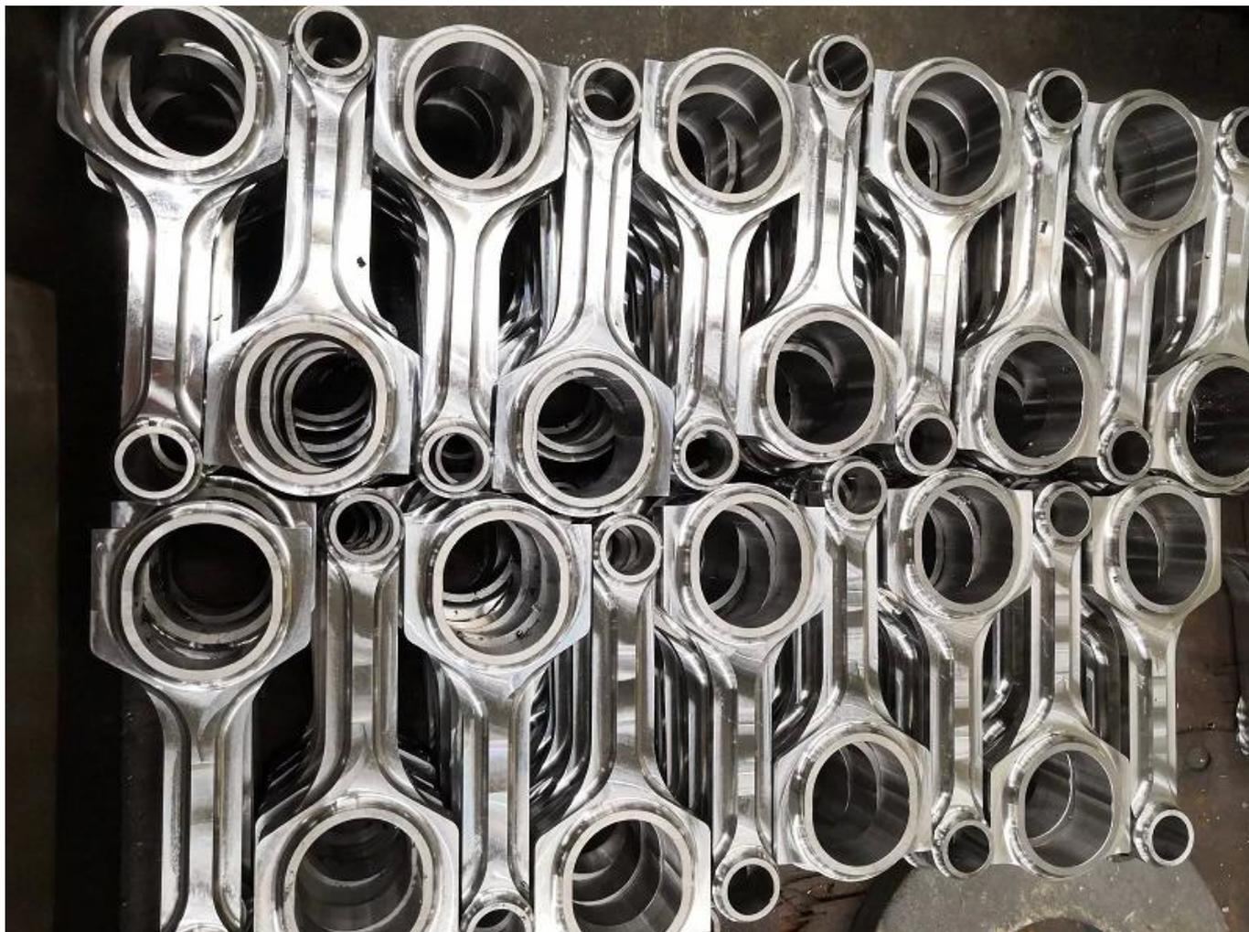
Nota: questa è la foto dopo l'avanzamento delle aste di collegamento bmw trave X fresate. per ulteriori progressi di produzione, si prega di controllare la nostra pagina di notizie: [Bielle Hurricane High Performance - Processo di lavorazione delle aste](#)
