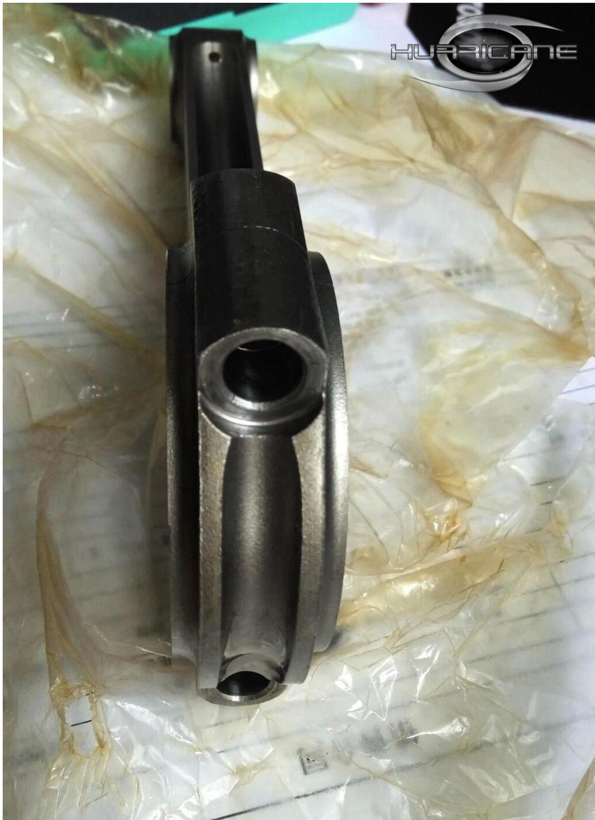
Per ogni asta trattata termicamente prima che i filetti siano tappati per proteggere bene i fili, e i veri bulloni ARP sono adatti per queste aste, è possibile installare facilmente i bulloni ARP sulle aste. L'uragano fornisce anche bulloni di bielle, non esitate a contattarci se siete interessati, è anche possibile visualizzare alcuni dettagli qui. [-Informazioni sul bullone di biella di uragano](#)
