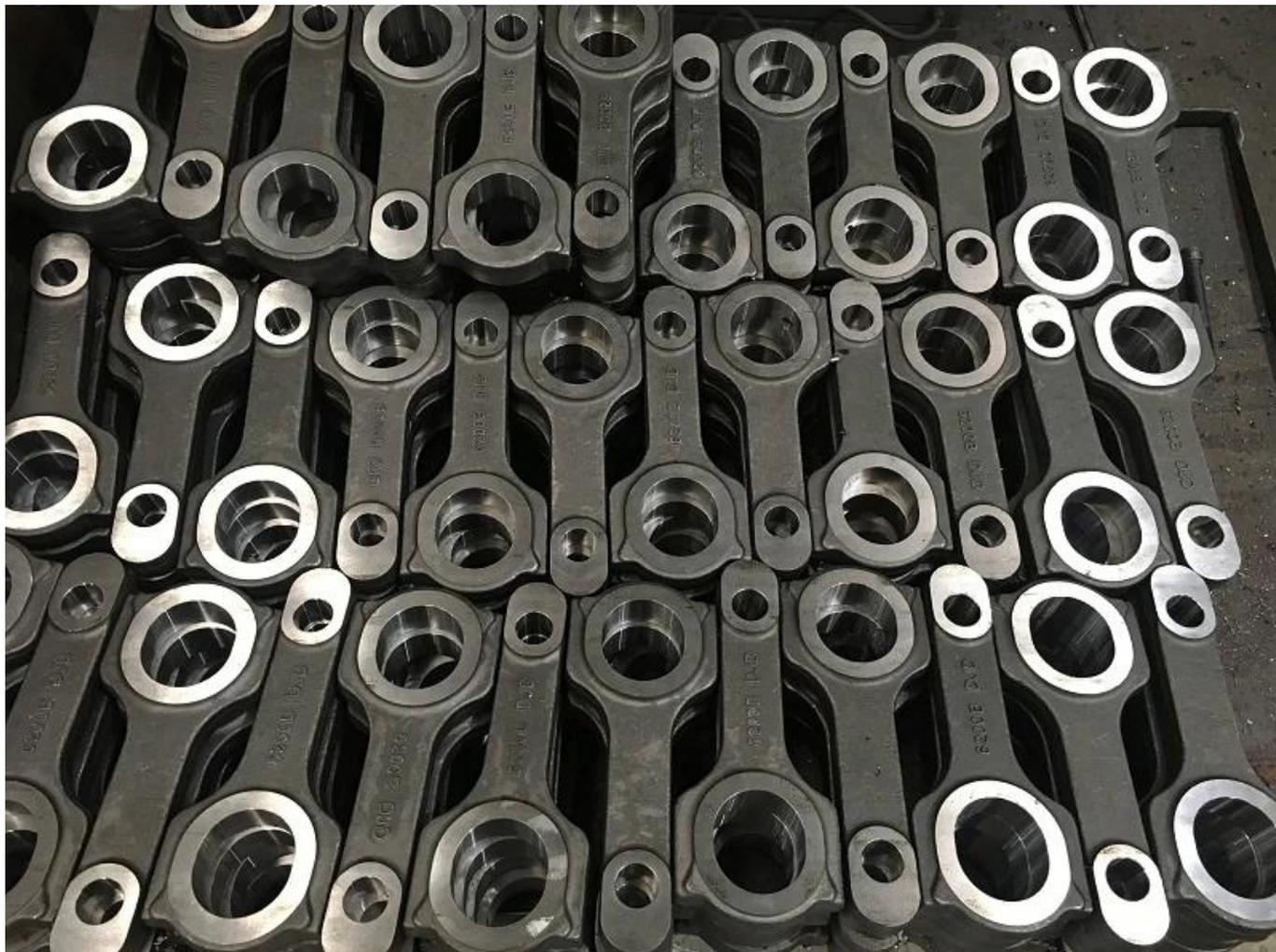
Nota: avanzamento della lavorazione delle bielle mazda mzr: trapanare il foro di testa grande e piccolo.
