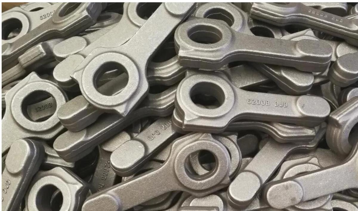
● Design: design H-Beam che fornisce rigidità estesa sotto carico verticale. L'opzione più venduta quando si tratta di bielle forgiate.
