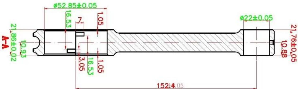
Le bielle Nissan Performance da 6.000 "152,4 mm sono direttamente compatibili con tutti i motori Nissan / Holden RB30, non richiedono lavorazioni di alcun tipo, sono adatte ai motori RB30ET (SOHC), RB30DET (DOHC) e RB30. Applicazioni I fori per l'olio dei perni forniscono ulteriore lubrificazione e raffreddamento. Il design del raggio H può sopportare carichi di compressione più elevati ed è anche conveniente per i clienti
