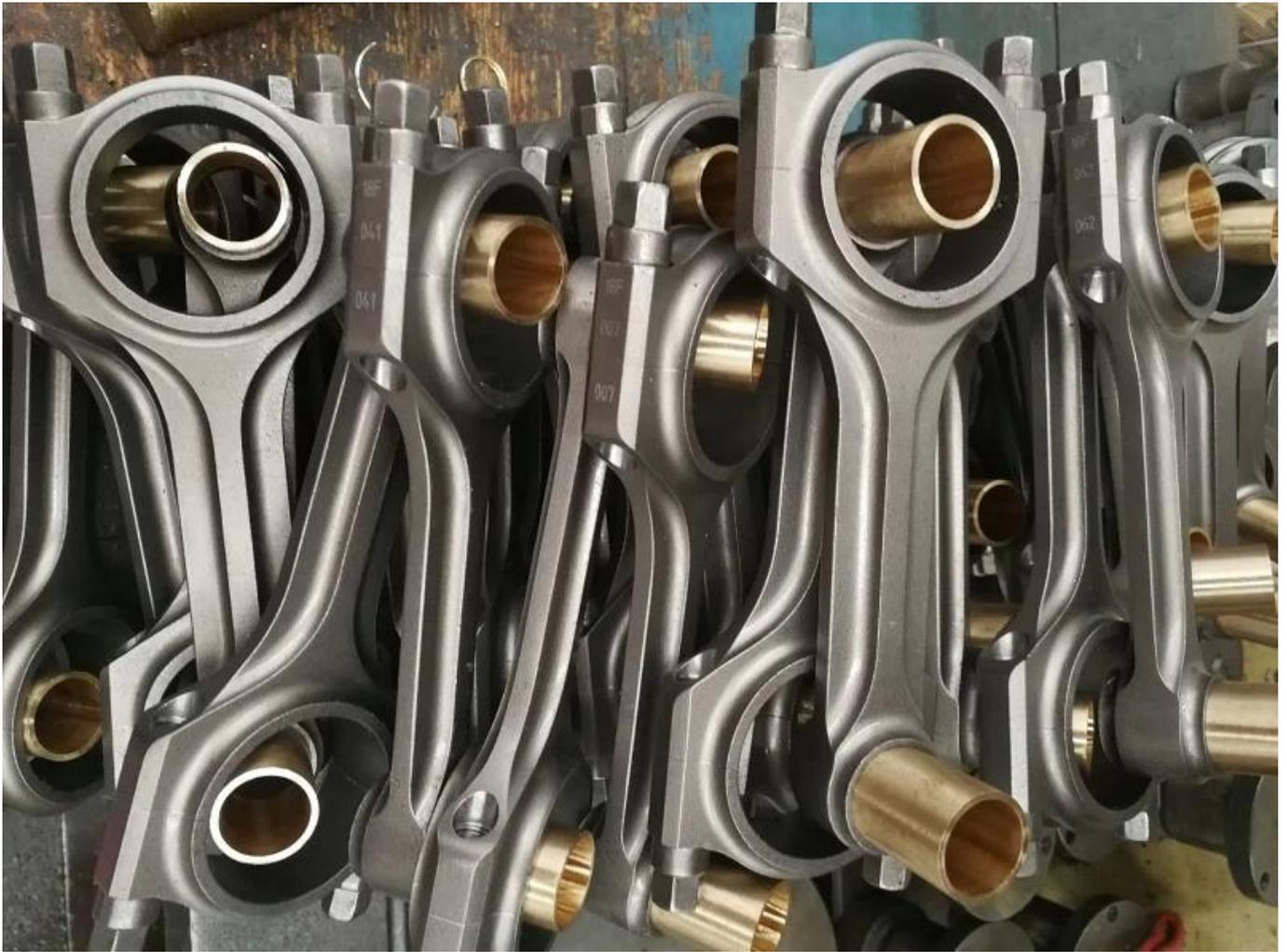
Ouragan Volvo 850 T5 C70 V70 2,3 L 4340 Les bielles X-Beam en acier forgé de 139,5 mm sont prêtes à être installées.
