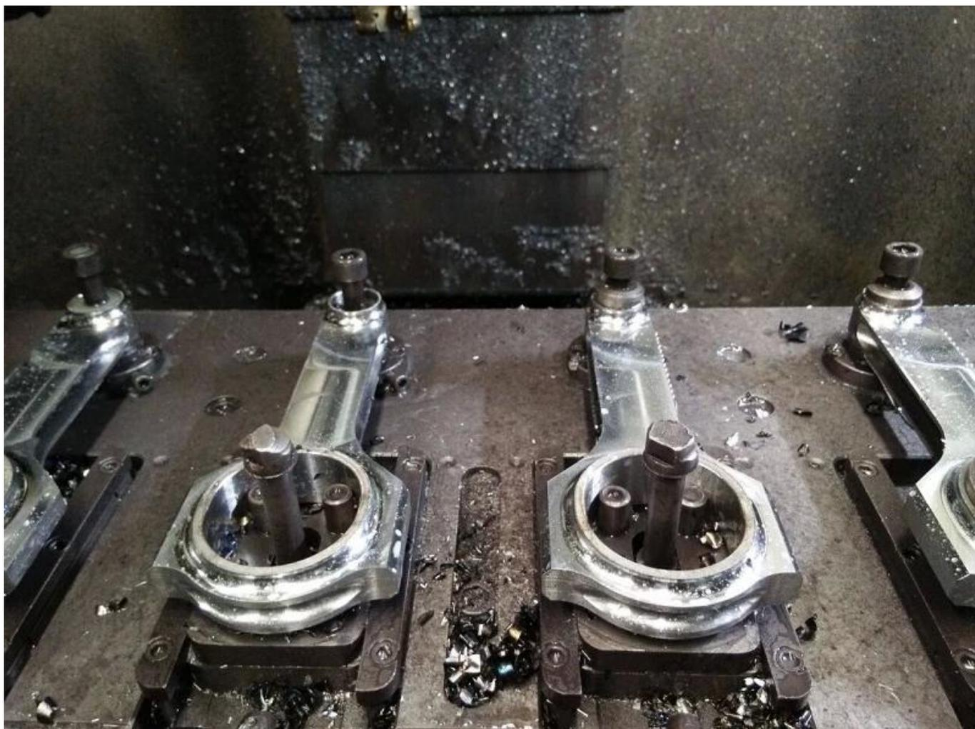
Ce n'est que l'un des progrès que nous avons réalisés sur les machines à commande numérique, pour vérifier plus de progrès dans la production des bielles d'ouragan, veuillez vérifier directement sur notre page de nouvelles: [Bielles Hurricane High Performance - Procédé d'usinage de tiges](#) Ou vous pouvez consulter notre vidéo de production directement sur Youtube Channel. s'il vous plaît cliquez sur le lien: [VERSION 2 Mode de réalisation: bielle forgée 4340 avec machine CNC](#)
