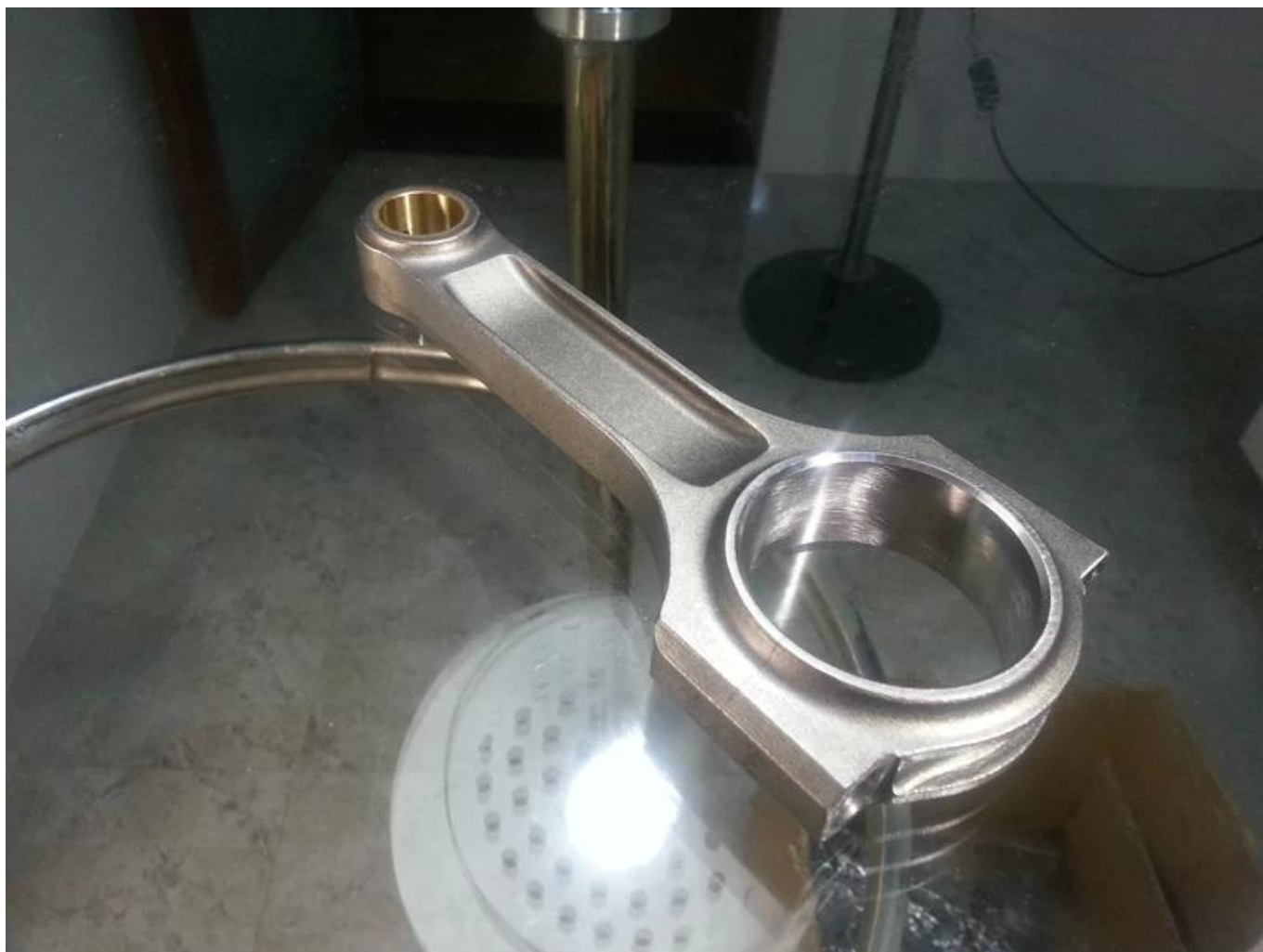
Bielles de poutre Audi VW 2.0L I avec conception de poutre I normale, veuillez vérifier l'image ci-dessous et VW 2.0L ABA 159mm forgé bielle poutre en I, 6.260 pouces de longueur
