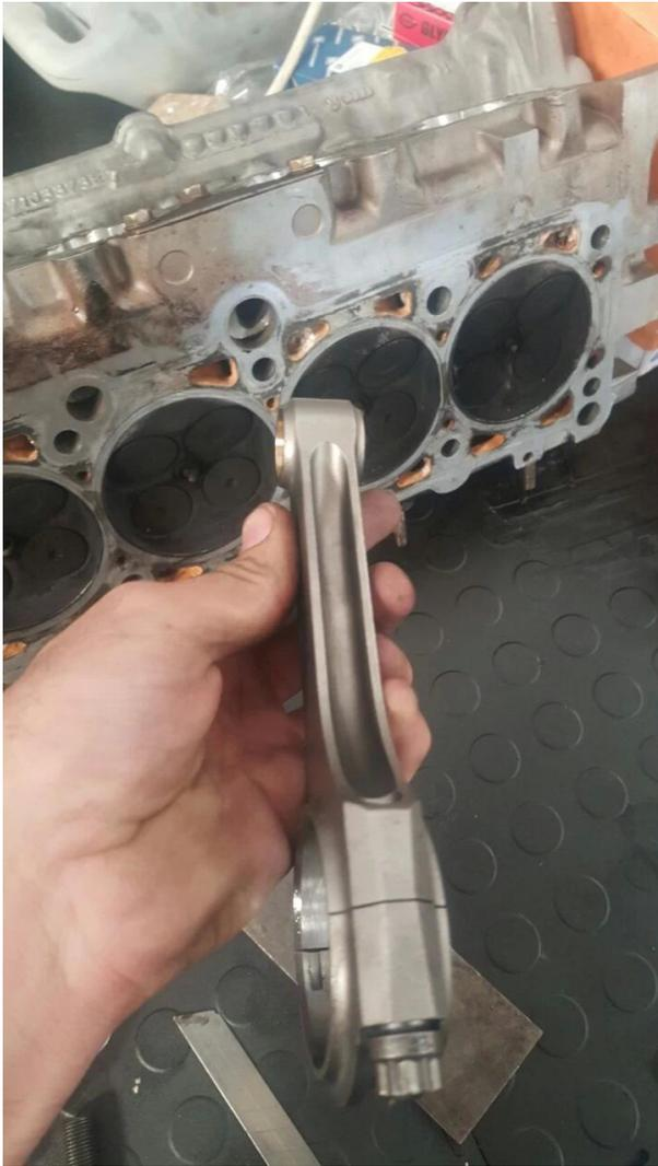
Noté: C'est Tiges de raccordement de faisceau H pour moteurs Subaru EJ20 / EJ25.
