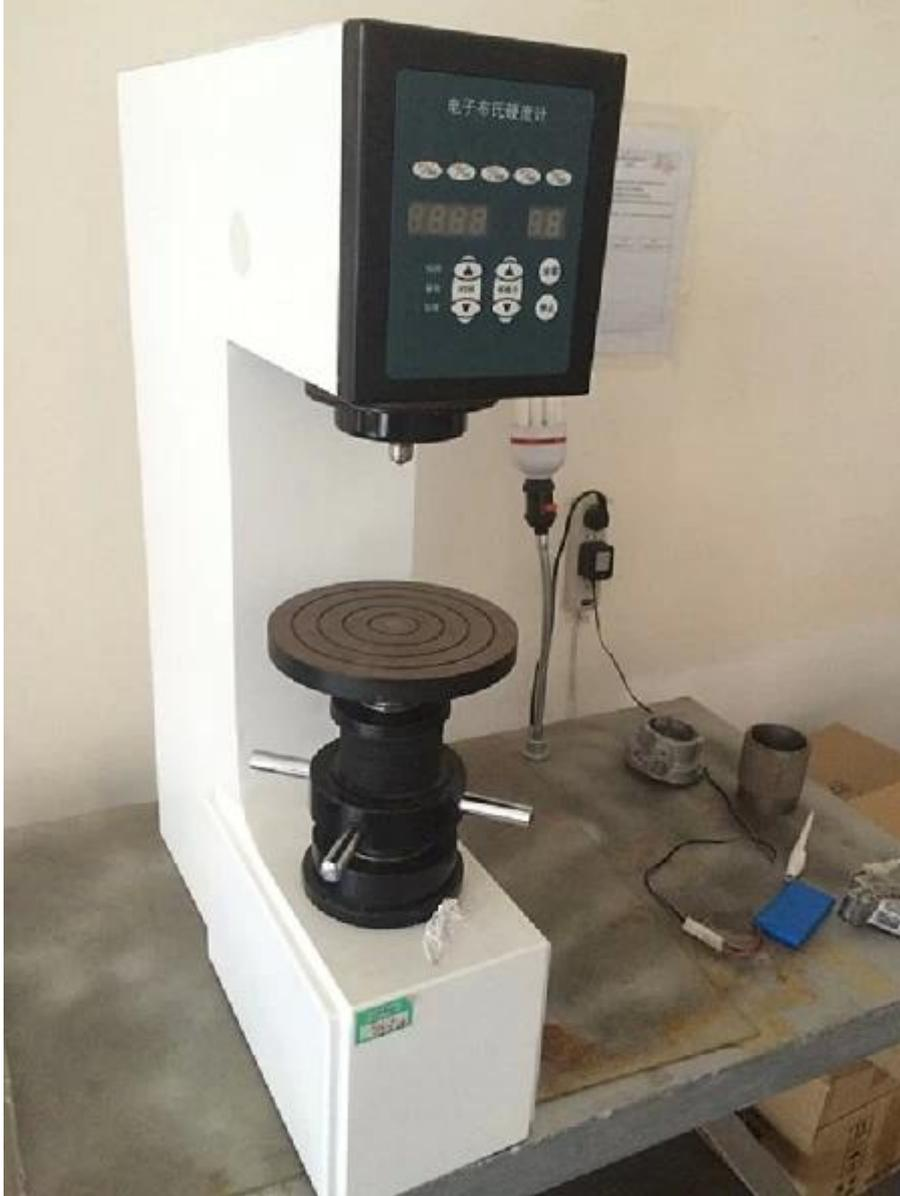
Note: Ceci est notre machine d'essai de dureté, les tiges de raccordement d'ouragan dureté 34-38 HRC.
