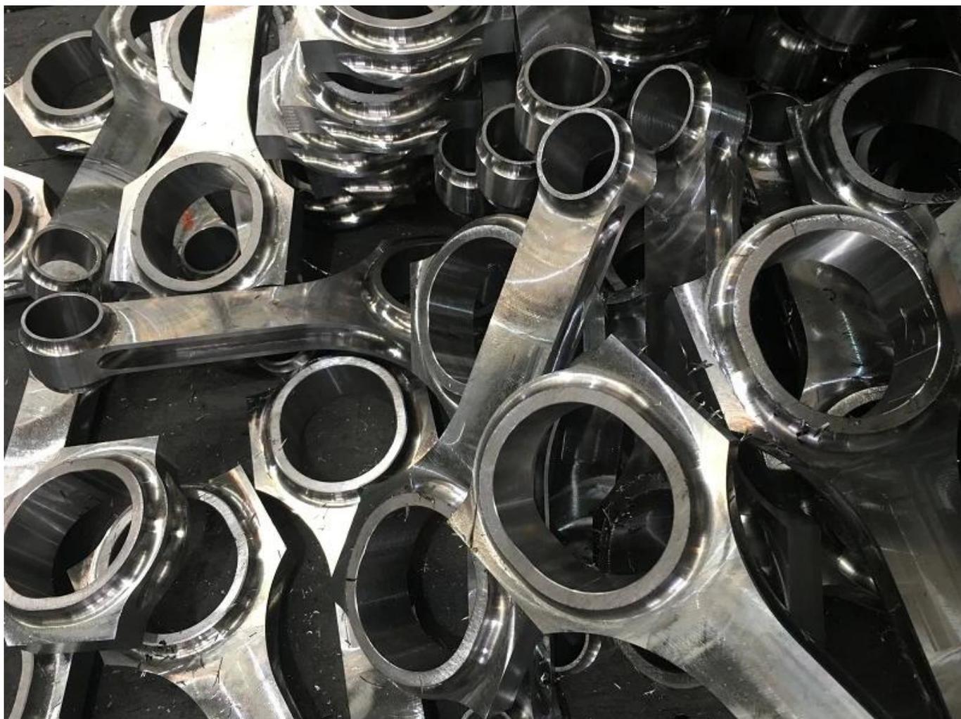
Remarque: Il s'agit d'une avancée des tiges de liaison du faisceau H de la fraiseuse MAZDA MIATA 1,6L / 1,8L.
