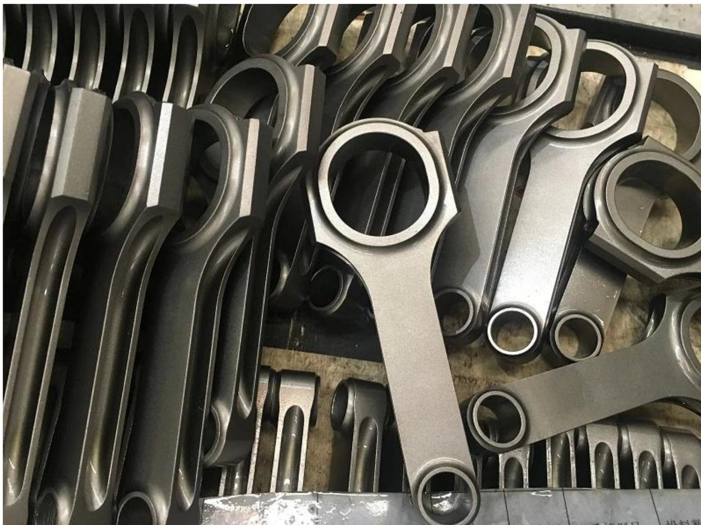
Remarque: Jeu de bielles de poutre en H forgées Mazda 323 MX-5 Miata B6 1,6 litre à DACT à densité de force supérieure à 1,8 litre après une montée en charge.
