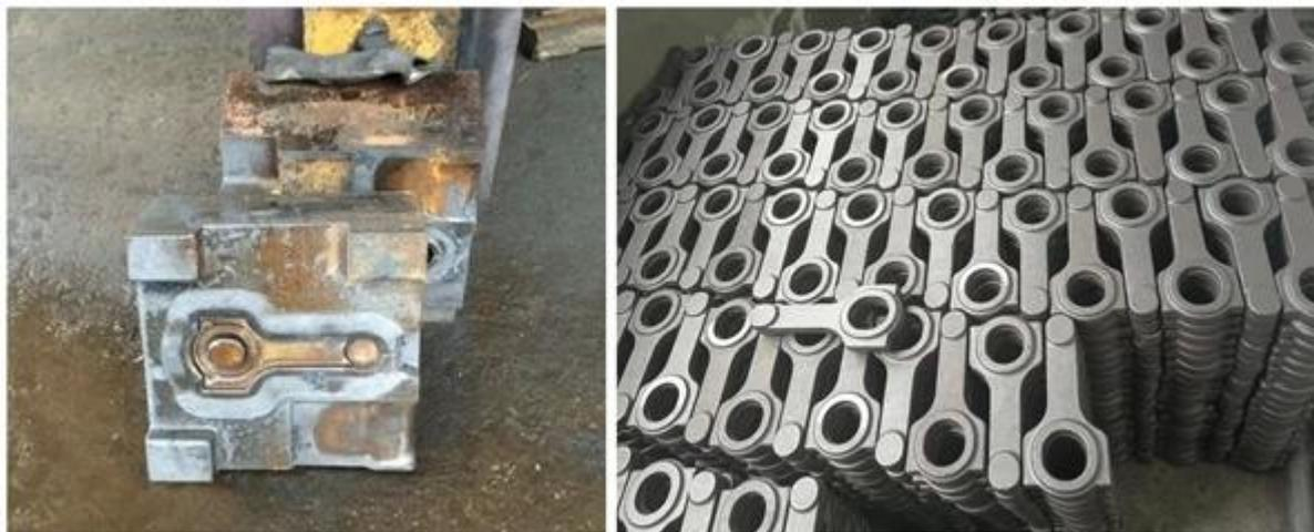
Ensuite, usiner des tiges sur des équipements allant de la forge à la fabrication des tiges finies
