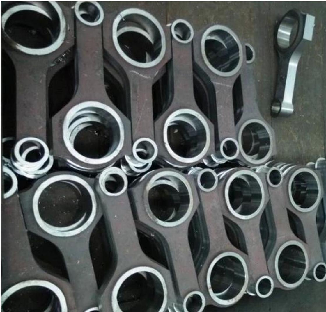
**Remarque: il s'agit d'une progression de percer Bielles de rechange en acier forgé pour moteurs Buick alésage des extrémités grandes et petites, qui agit comme un localisateur fiable dans tous les processus.**
