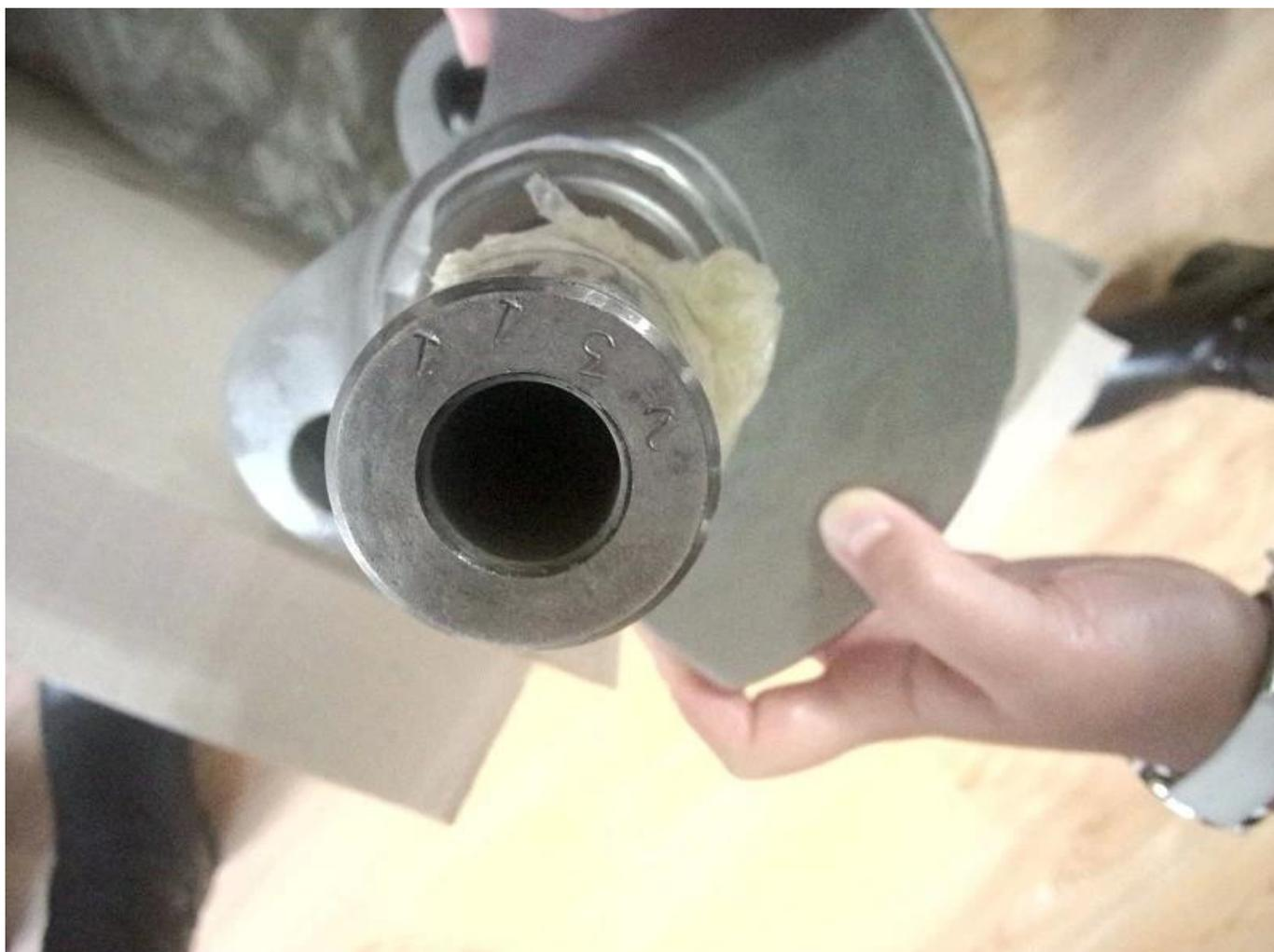
Le vilebrequin en acier Forgé 4340 forgé de 3,900 "LS1 forgé LS1 est également rectifié à la taille EXACT, magnafluxé et équilibré dynamiquement, et chaque pièce de nos manivelles LS1 a un numéro de série (marque d'identification).
