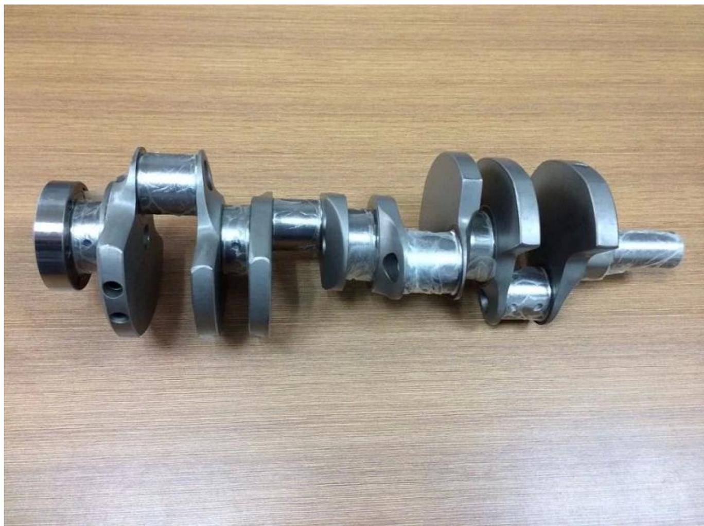
Il s'agit de notre Chevrolet Cry LS1 Forged Crank 3.900 ", conçu pour les applications de performance pour les applications hors route, de rue et de course. Toutes les manivelles forgées GM LS1 4340 sont usinées CNC à partir d'une seule pièce d'acier chromé forgé, polies et polies. Nitruré. La nitruration est un processus coûteux où le vilebrequin est exposé au gaz sous la chaleur et la pression, ce qui crée un journal très dur et strength ajouté.
