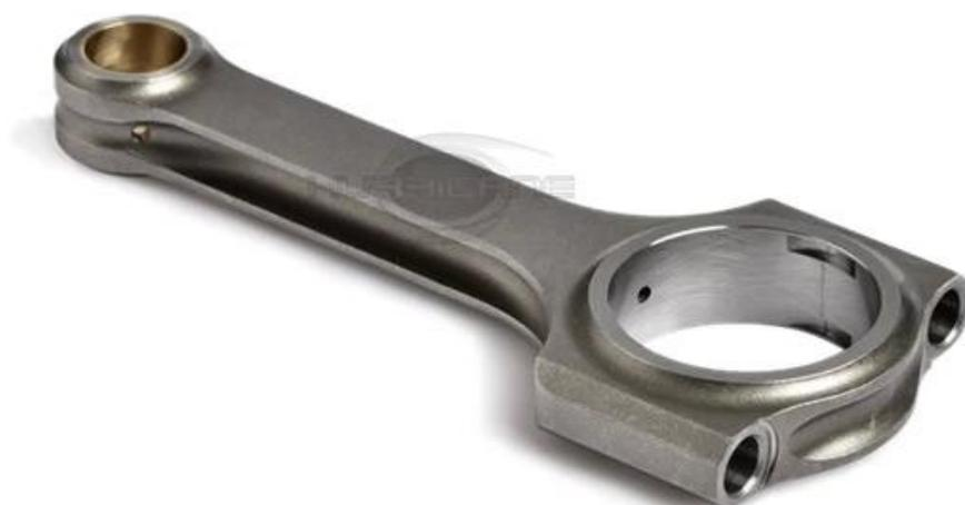
Les bielles Hurricane pour Honda B16 sont séchées et polies, ces processus éliminent les bavures et rendent la surface lisse. également grenailée, ce processus signifie que la petite balle frappe la surface et les fait surface, augmente la résistance des tiges. Nous employons également la machine à affûter Sunnen
