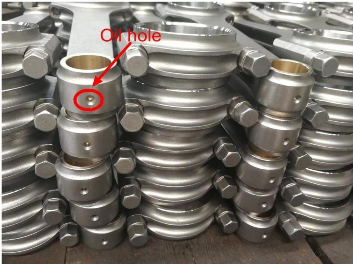
Remarque: il s'agit d'un seul trou d'huile pour. **Réservoirs d'huile double PE** peut être fourni si nécessaire.
