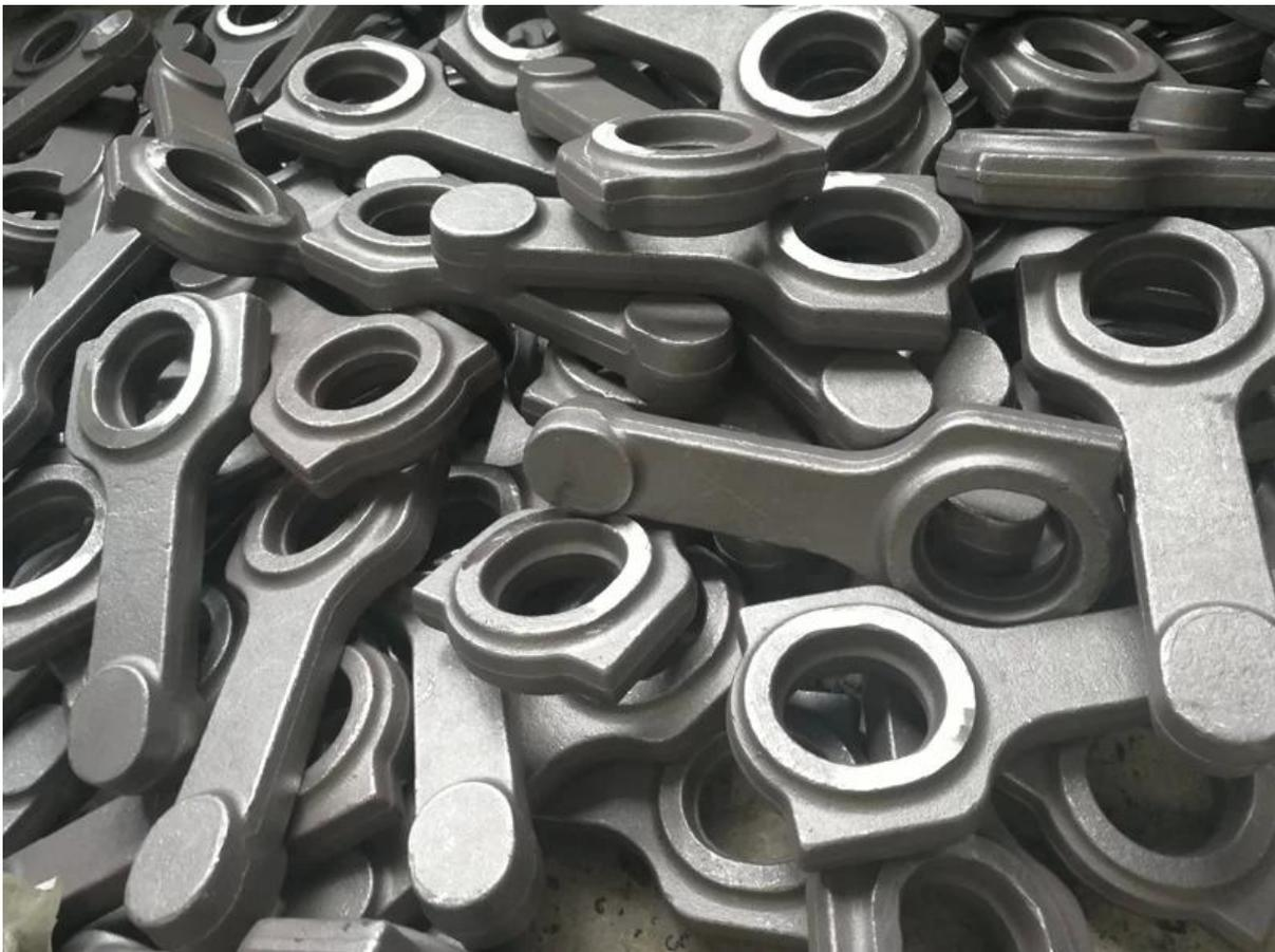
Remarque: Forge en une pièce, HRC: 34-38. le matériau est manipulé par des pinces et placé dans chacune des empreintes de bielles sculptées dans un bloc de matrice. Au fur et à mesure que le marteau exécute le marteau, il déplace le métal chaud blanc doux dans chaque empreinte, formant progressivement la bielle. Le marteau, qui impose une force de 3 000 lb, impacte le matériau une frappe par seconde. Trois coups de marteau et la bielle sont forgés.
