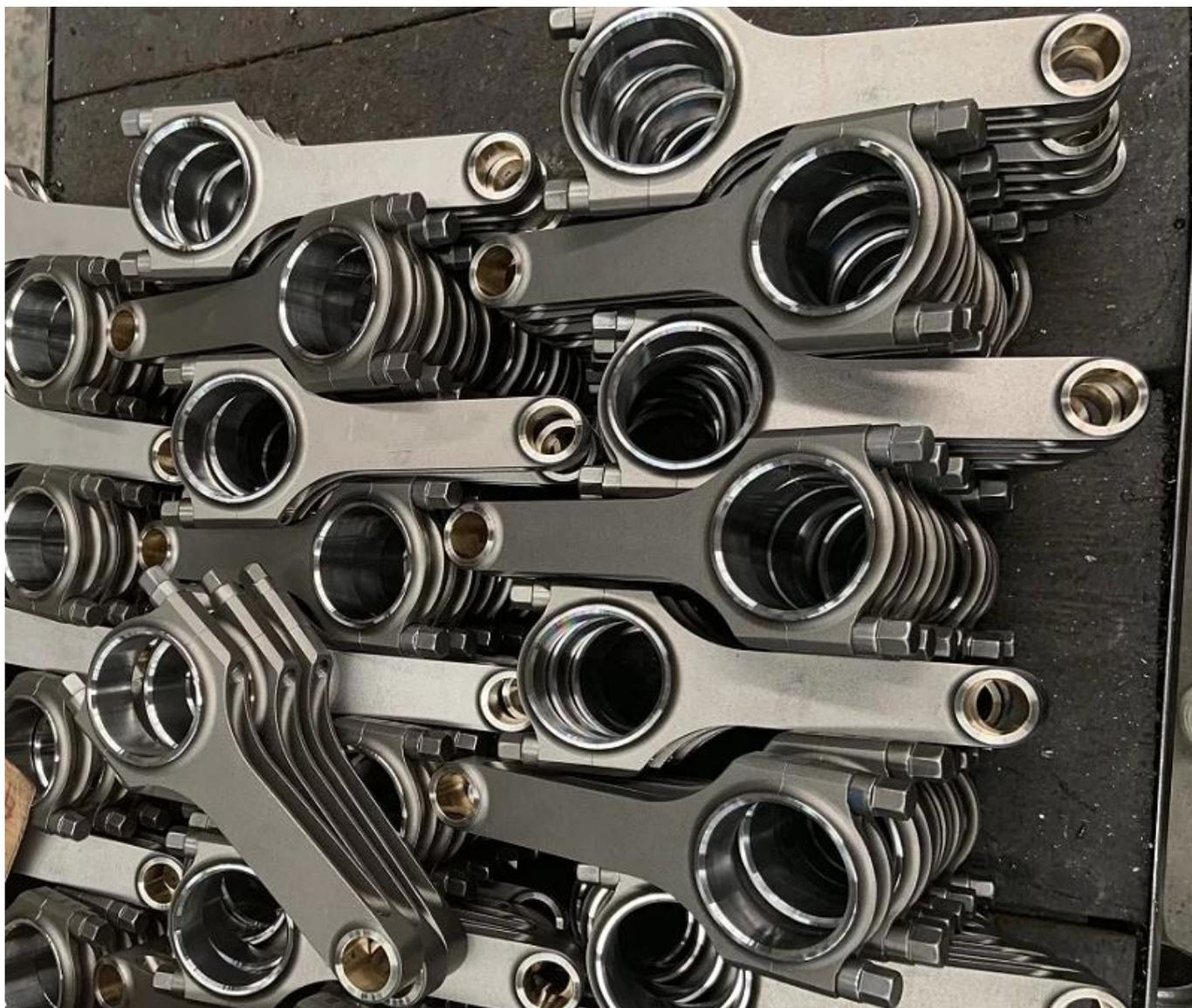
Ces bielles de poutre Honda F23 H sont prêtes pour l'emboutissage, l'étiquetage des roulements et l'emballage. Informations de montage en dessous:
