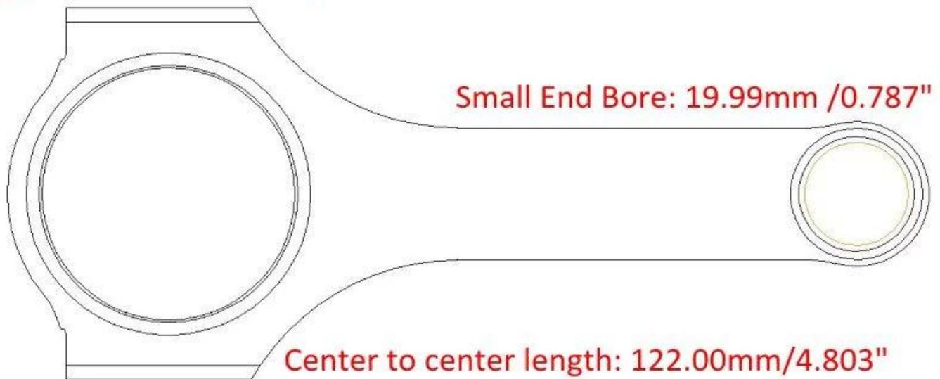
Hurricane Manufacturer produit des bielles de poutre en H pour Toyota Moteurs Celica Corolla MR2 4AG 4AGE AE86 GTS 1.6L.
