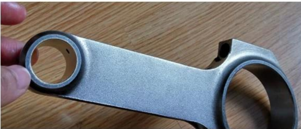
Bielles, 5,400 "longueur, 3/8" boulons ARP, H-Beam, VW Journal, ouragan Speed & performance course bielles, vendu comme Set. MOQ: 80pcs pour de nouveaux clients.
