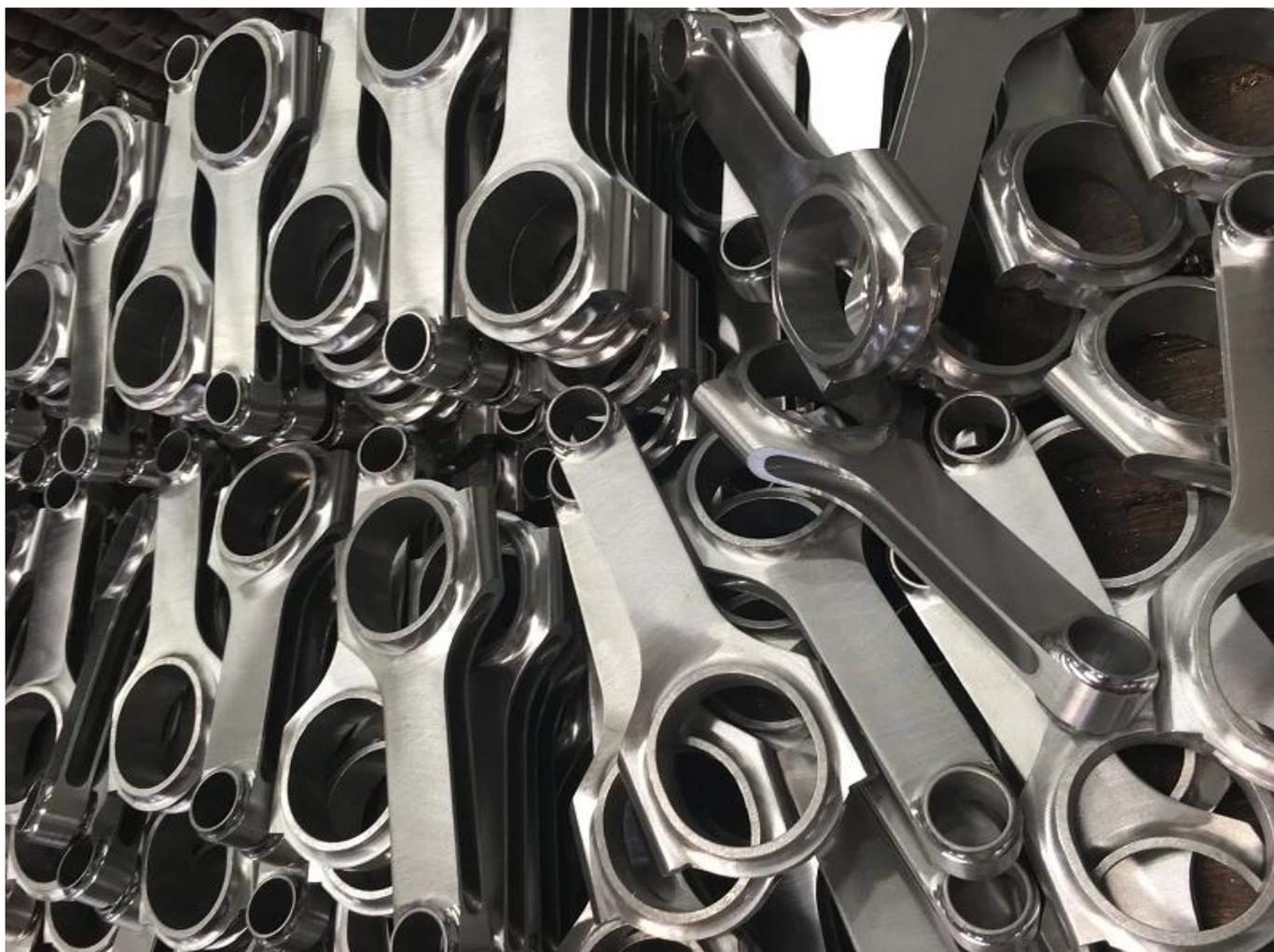
Remarque: bielle en forme de poutre en H pour la machine de polissage BMW E30 M3 S14 dans l'usine Hurricane.
