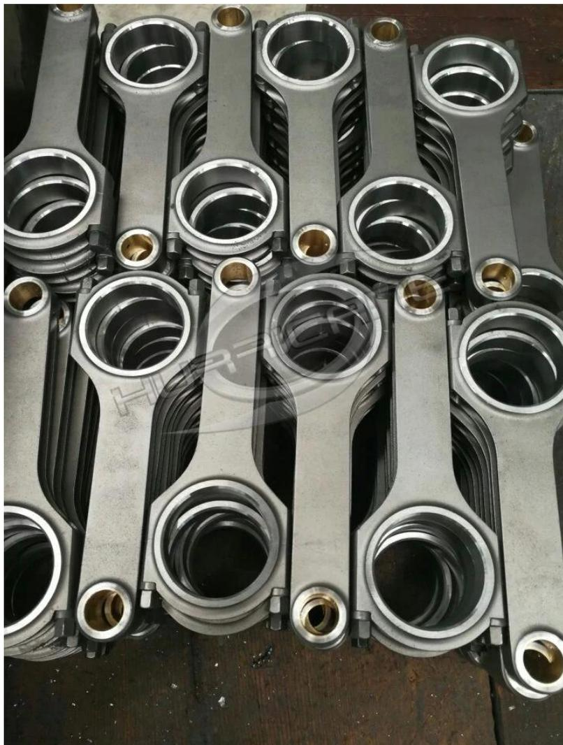
Des douilles de poignet en bronze de haute qualité sont montées sur chaque tige pour accroître la résistance à l'usure.
