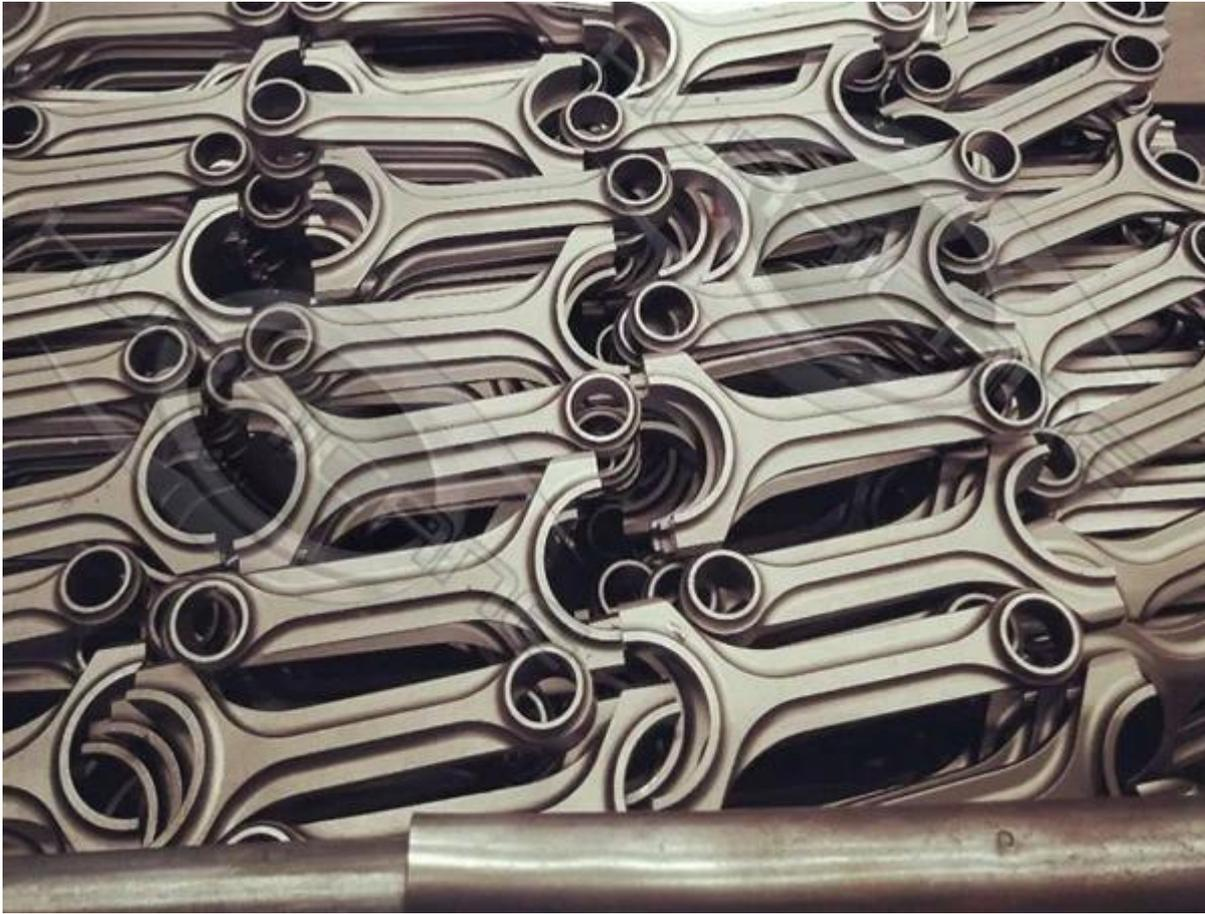
6) Aiguisé avec la machine à roder SUNNEN pour une tolérance serrée
