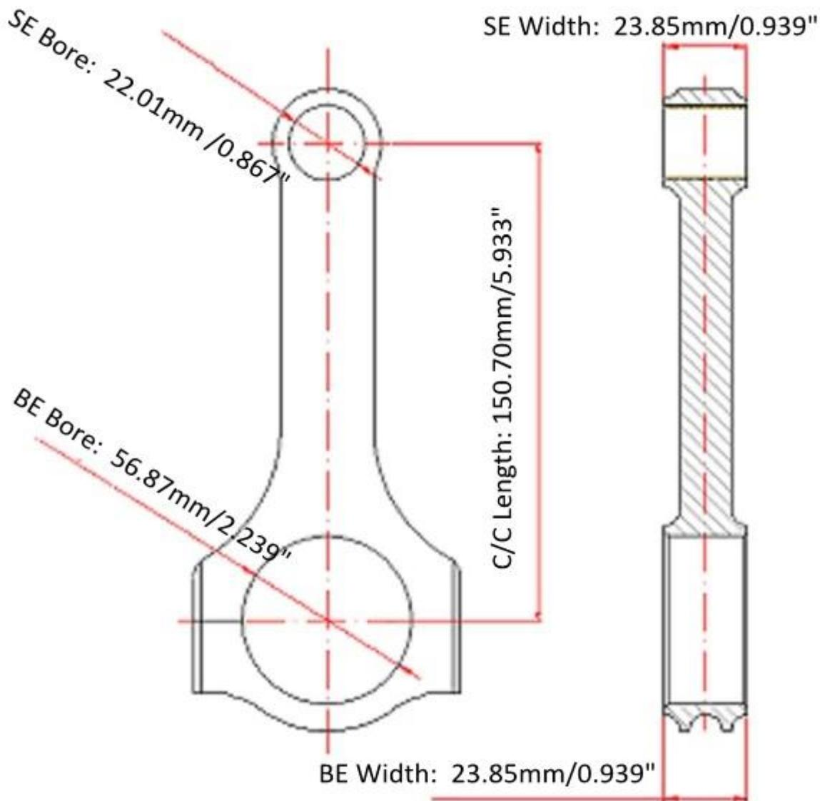
Hurricane Ford 4.6L moteur H-Beam 5.933 "Les bielles sont fabriqués à partir [Acier forgé 4340](#) Matériau de bielle, conçu et fabriqué pour les applications Ford Coyote de 4,6 L / 5,0 L, 100% usiné CNC, allégé de contrainte et magnafluxé, il supporte plus de 1000 HP pour les moteurs de course Ford.
