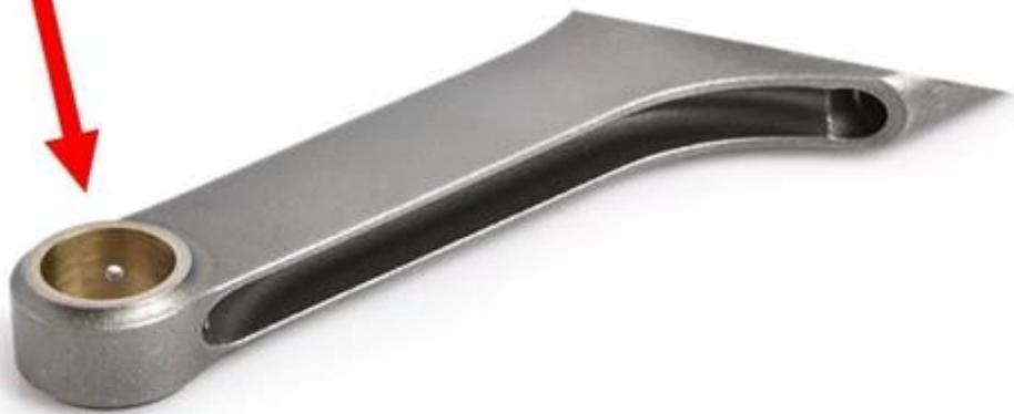
Un trou d'huile a été percé au sommet de la petite extrémité pour permettre une lubrification suffisante du piston et augmenter sa durée de vie.
