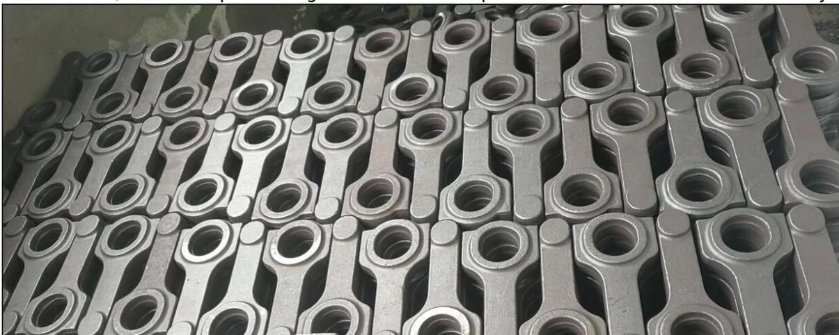
Ensuite, en les usinant sur une machine CNC, grenailage, grenailage
