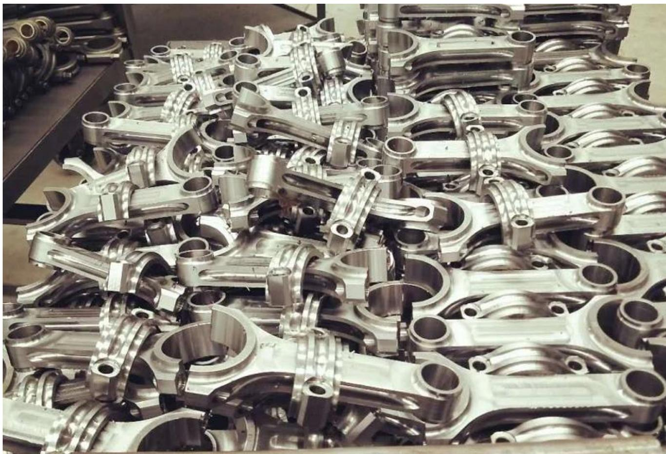
Hurricane a des poutres en H, des poutres en X et des poutres en I pour les bielles Buick Series II L67 V6.
