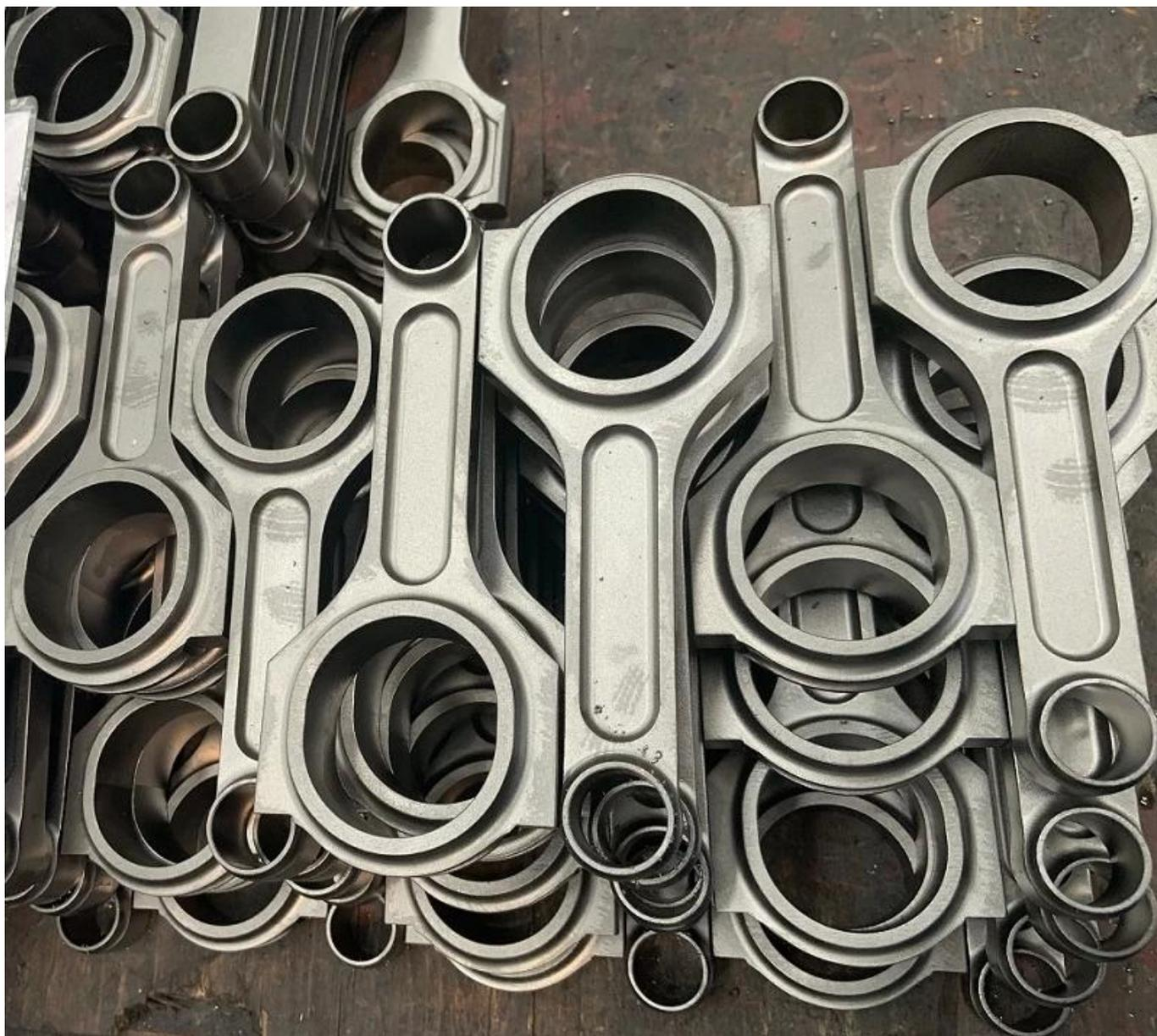
Remarque: les bielles en acier forgé BMW E46 M3 S54 de 139 mm de largeur I sont prêtes à être peintes. Vous pouvez vérifier plus de détails sur ces progrès à la page Nouvelles: [Tiges de liaison Grenailage et mirco-polissage, aspect spécial au niveau A](#)
