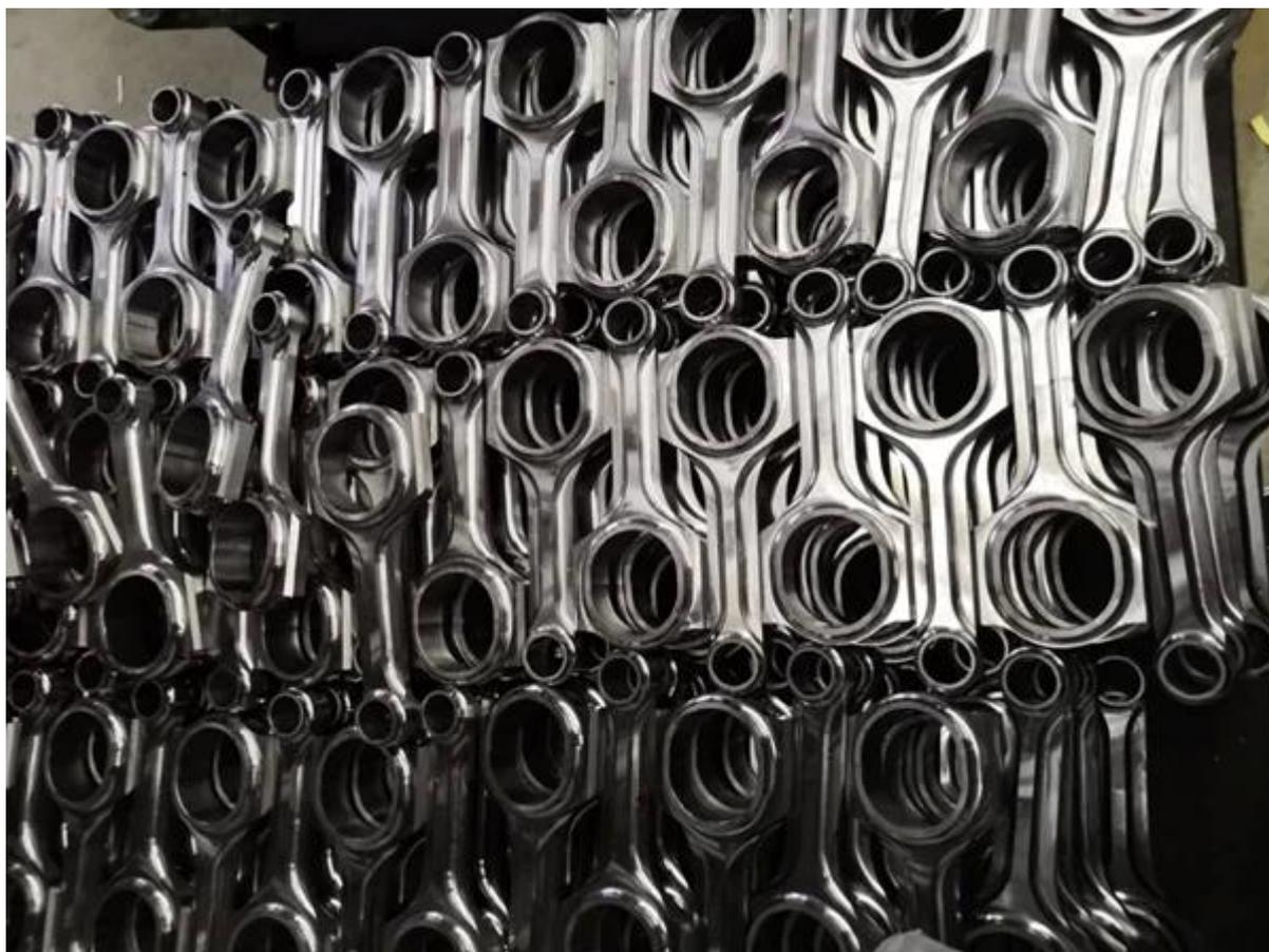
**Tiges de raccordement de poutres x finies**
