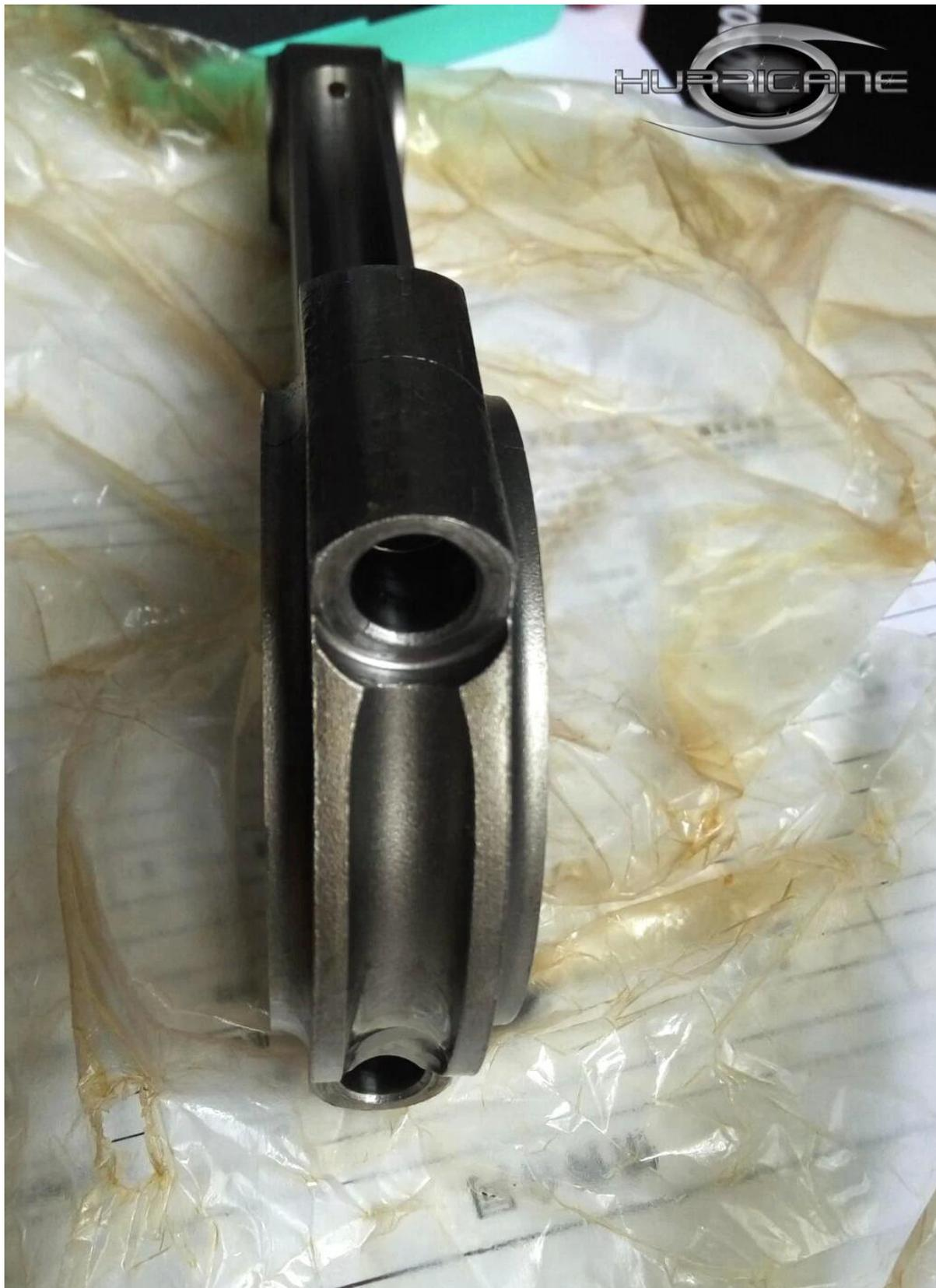
Par tige traitée thermiquement avant que les filets taraudés ne protègent bien les filets, et que les boulons ARP authentiques soient adaptés à ces tiges, vous pouvez facilement installer les boulons ARP sur les tiges. Hurricane également fournir des boulons de bielles, s'il vous plaît n'hésitez pas à nous contacter si vous êtes intéressé, vous pouvez également voir quelques détails ici. [-Informations sur le boulon de bielle de l'ouragan](#)
