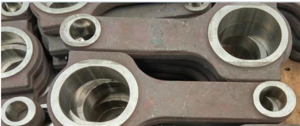
2. Ferçu **Forme de faisceau i** Pour fournir une meilleure combinaison de poids léger et de résistance, chaque chaleur de tige traitée à HRC 34-38 puis grenillée pour une résistance à la fatigue supérieure, emballée avec un équilibrage optimal d'équilibrage optimal pour poids  $\pm 1$ Gram par ensemble.
