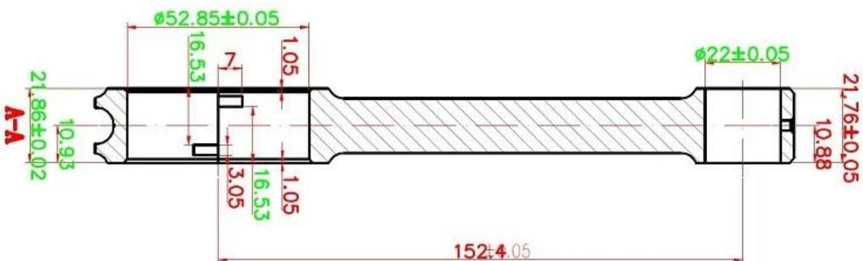
Les bielles Nissan Performance 6.000 "152.4mm s'adaptent directement à tous les moteurs Nissan / Holden RB30. Aucun type d'usinage n'est requis. Elles conviennent aux moteurs RB30ET (SOHC), RB30DET (DOHC) et RB30. applications Les trous d'huile d'extrémité des broches offrent une lubrification et un refroidissement supplémentaires. La conception des poutres en H peut supporter des charges de
