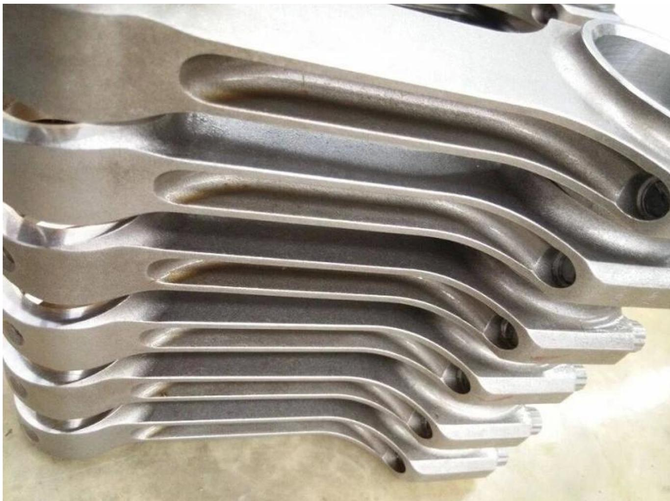
Hurricane Speed And Performance En tant que fabricant de bielles diesel, toutes nos tiges forgées Isuzu 158mm représentent la plus haute qualité et sont conçues pour une puissance maximale. n'hésitez pas à [Contactez nous](#) et enquête notre échantillon de bielles de moteur diesel ou demande le prix.
