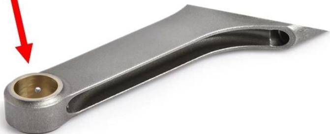
Même avec tous les 4340 de haute performance des tiges de connexion forgées dans l'industrie de la course, toutes les tiges F20C 100% X-rayed, Sonic testé, magnafluxed et Shot grenailé pour une meilleure longévité de la fatigue.
