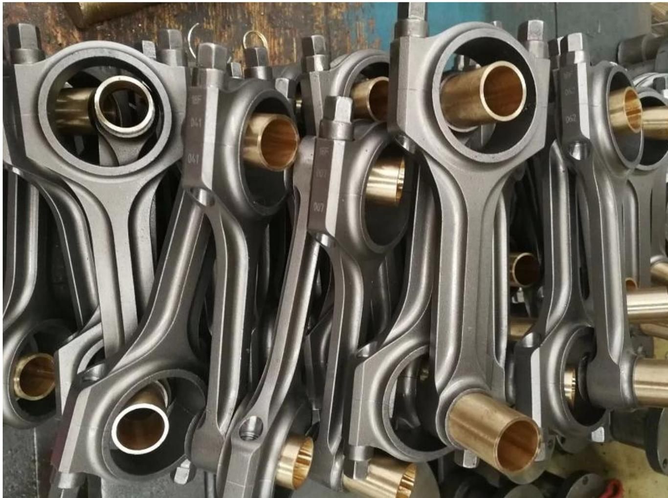
Las bielas Huracán Volvo 850 T5 C70 V70 2.3L 4340 de acero forjado X-Beam 139.5mm están listas para instalar bujes.
