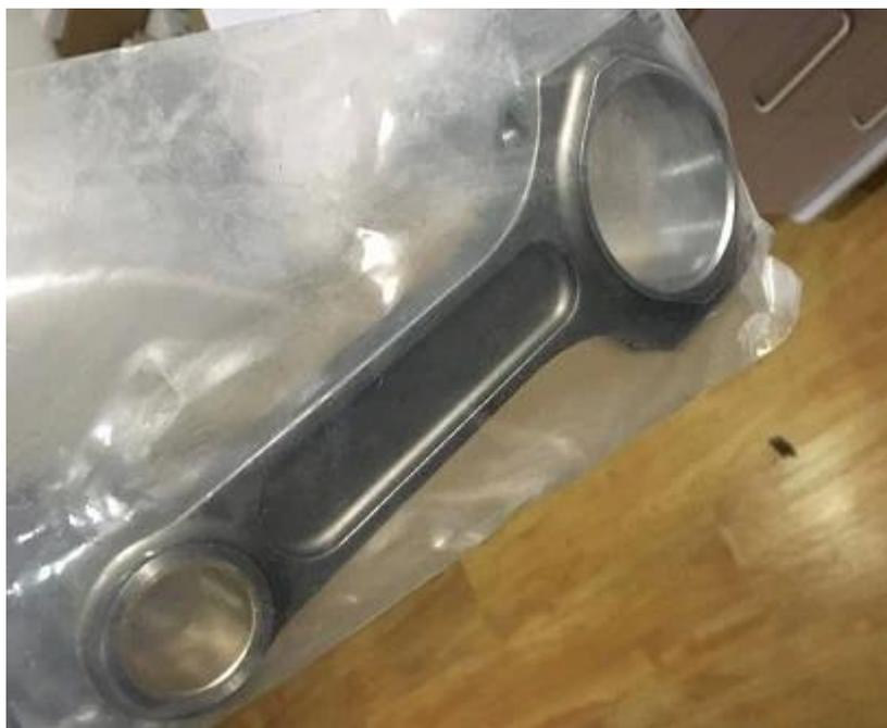
Para mayor durabilidad, los sujetadores de tornillo de la serie SPEC de huracán Race se utilizan para asegurar las tapas de varillas de 2 costillas de alta resistencia. el 164 x 20 mm forjado barras VR6 puede utilizar tanto 3/8 "y 5/16" bielas pernos, huracán Race Spec 5/16-1.500 "par de pernos es 45N \* m, huracán Race Spec 3/8-1.600" pernos de torsión es 75N \* m. Nuestros pernos de biela PSI podían alcanzar 211.829. Puedes [Consulte el informe de prueba en nuestra página de certificación](#).
