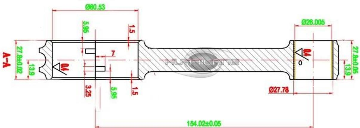
Hurricane forged 4340 steel Las varillas de conexión para Toyota 1FZ 1FZFE 154mm Rod Length están perfectamente maquinadas y afiladas para usar en tamaño. La biela de conexión Hurrican I-Beam está diseñada para las aplicaciones en las que la resistencia de la biela es la preocupación número uno con más de 1000 + HP por juego.
