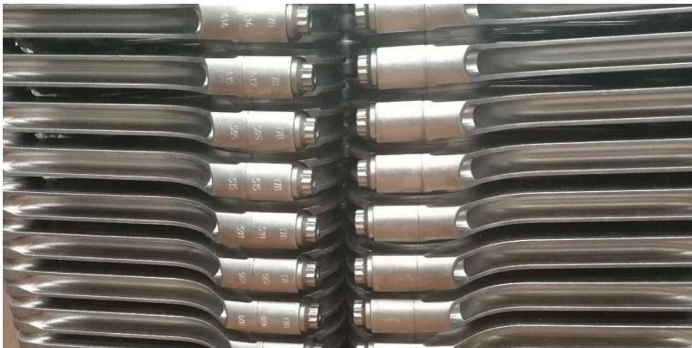
Nota: El lado del hombro también se utiliza para las marcas de identificación permanentes, que se utilizan específicamente para volver a unir la varilla y su tapa después de que la herramienta de separación la haya cortado. Puedes consultar más información detallada de los avances en: [Bielas Hurricane High Performance - Proceso de mecanizado de bielas](#) O consulte nuestras operaciones en Youtube Viedo: [Cómo está hecho: Biela](#)
