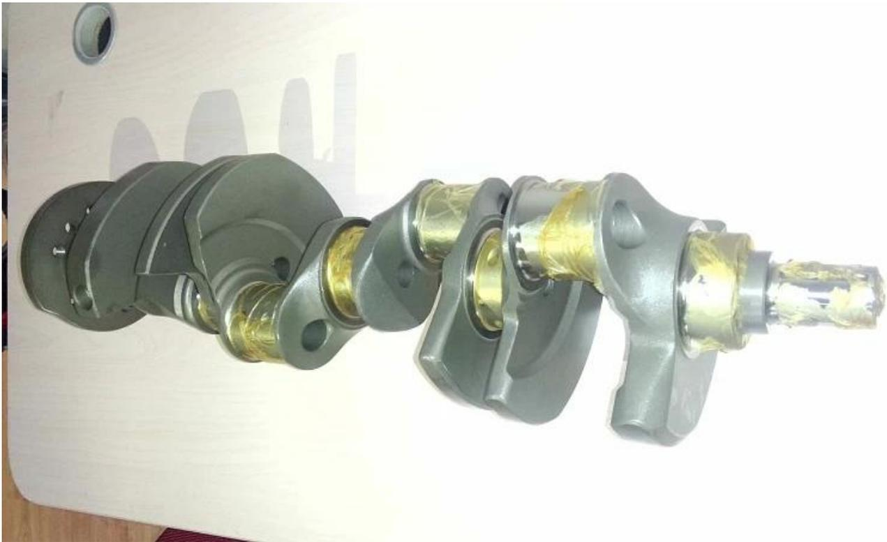
El cigüeñal forjado Chevy 350 de bloque pequeño flanqueado y perfilado ha sido mecanizado y granallado, aumentando la intensidad de manera efectiva
