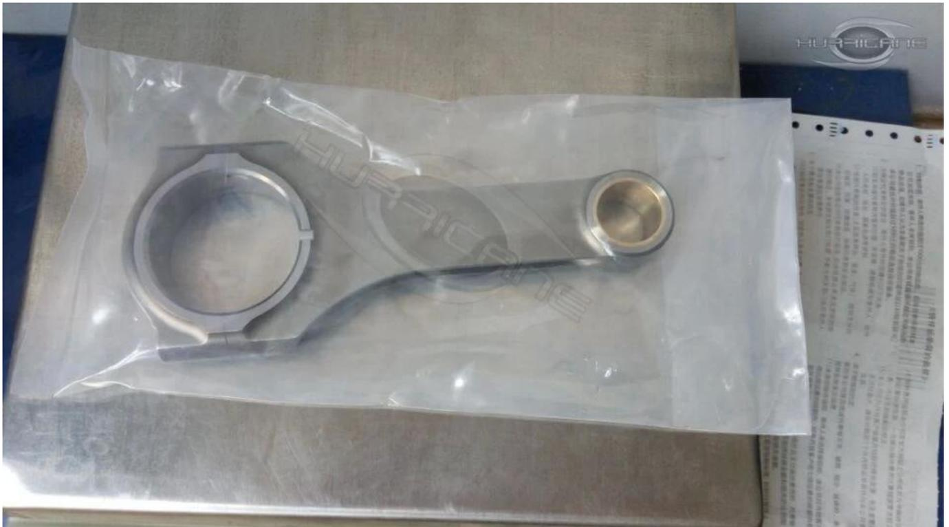
BMW M20 140mm H-beam Rods Packing Imagen para referencia como a continuación, estas varillas se empacarán bien con aceite y papel antioxidante para proteger bien a las varillas durante el transporte
