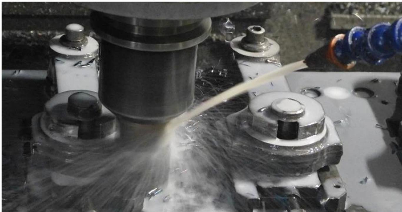
Nota: Este es uno de los avances de nuestra producción: esta máquina de avance mide la superficie exterior de la viga a la medida y completa la operación de rebaje con una fresa de punta esférica, lo que confiere a la viga en H su configuración. puedes consultar nuestro video de producción de youtube: [VERSIÓN 2 Cómo está hecho: 4340 biela forjada con máquina CNC](#) O consulte más detalles en nuestra página de noticias: [Bielas de alto rendimiento Hurricane - Proceso de barras de mecanizado](#)
