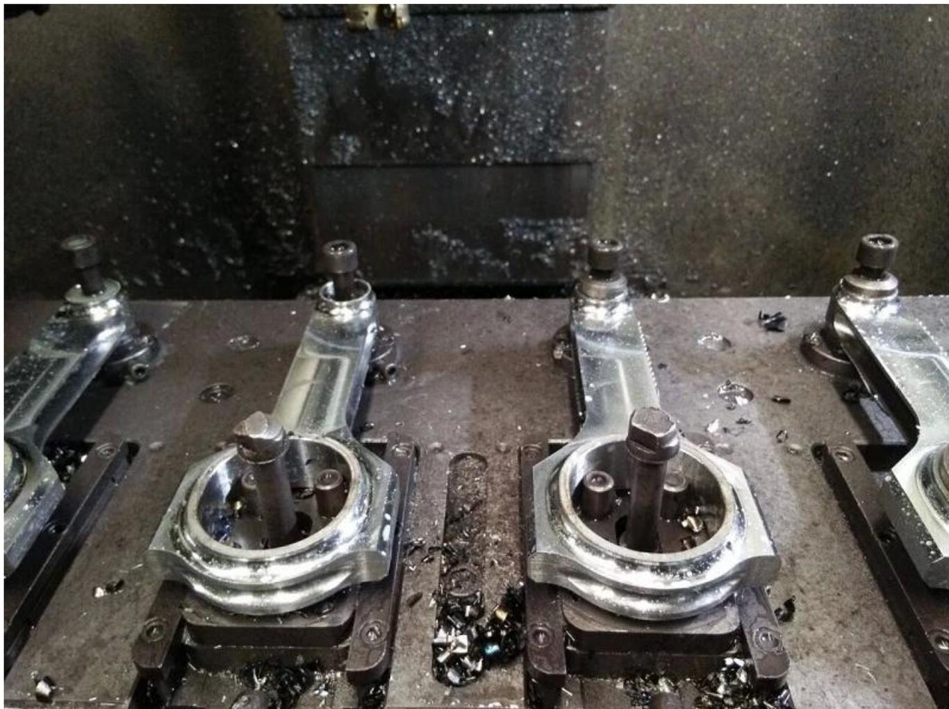
Este es solo uno de los avances de las bielas que mecanizamos en máquinas CNC, para verificar el progreso de la producción de varillas de conexión de huracanes, consulte directamente en nuestra página de noticias: [Bielas de alto rendimiento Hurricane - Proceso de barras de mecanizado](#) O bien, puede consultar nuestro video de producción directamente en el canal de Youtube. por favor haga clic en el enlace: [VERSIÓN 2 Cómo está hecho: 4340 biela forjada con máquina CNC](#)
