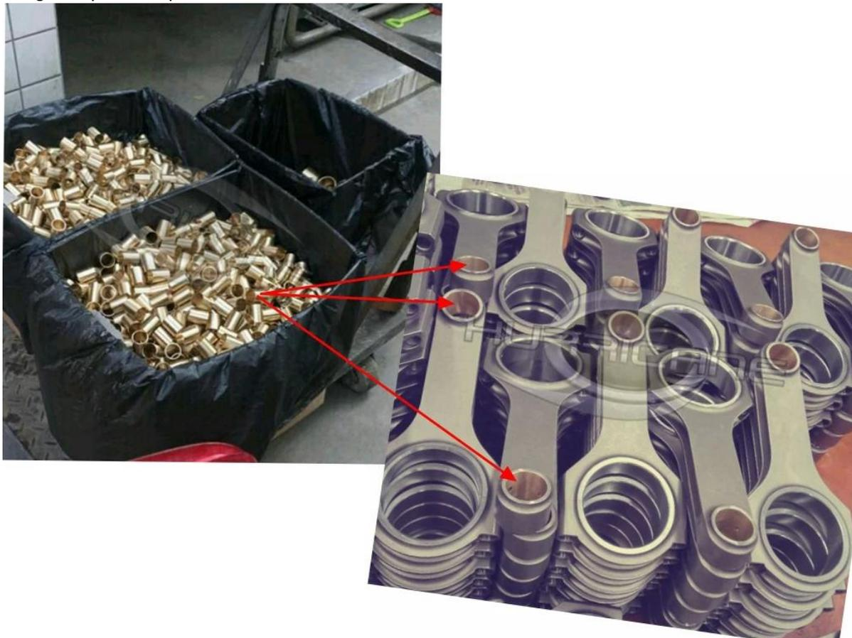
Doble los orificios de aceite perforados en el extremo pequeño de la barra para proporcionar lubricación positiva del extremo pequeño.
