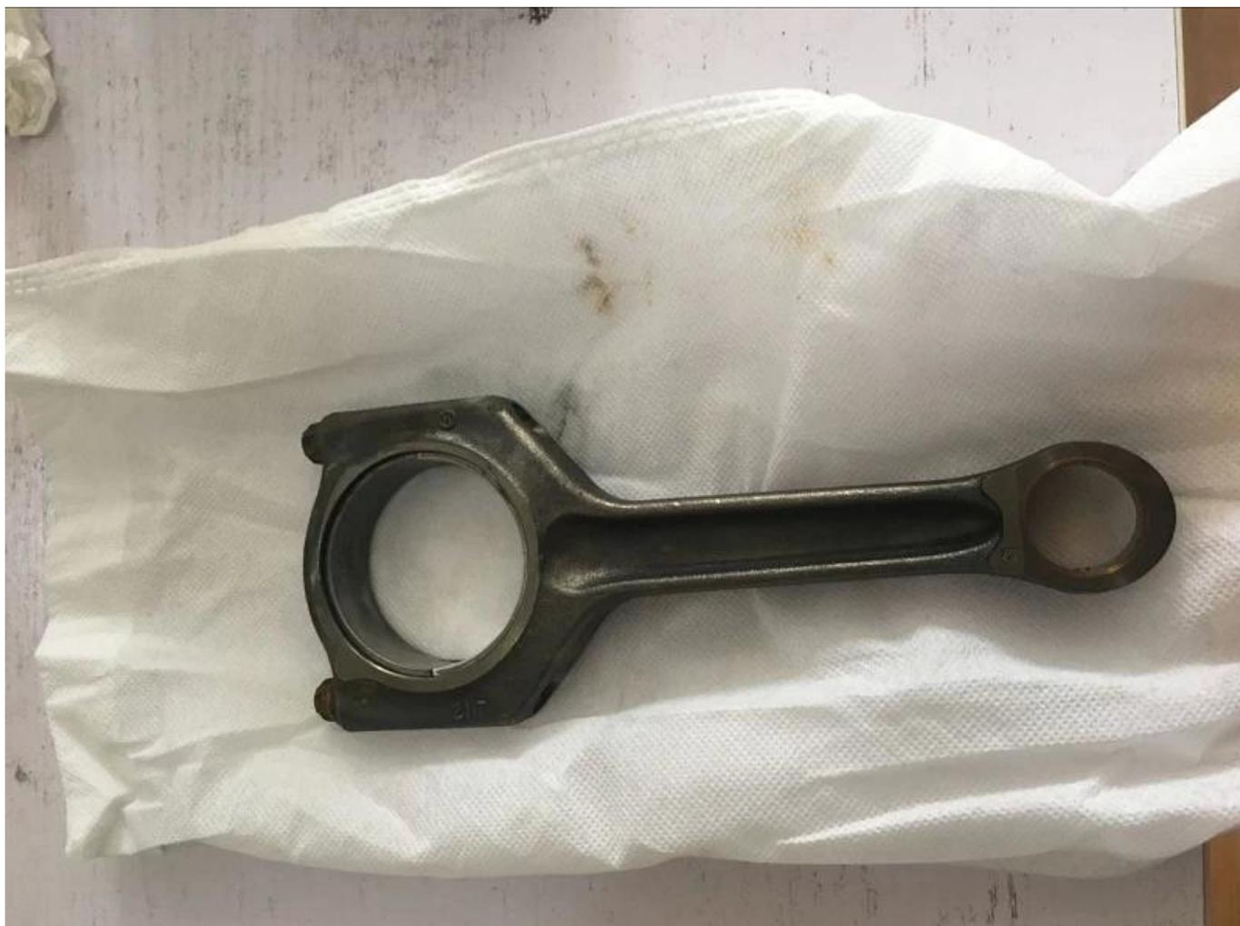
Las bielas de alto rendimiento Hurricane BMW N54B30 de 145 mm están completamente mecanizadas por CNC, antes de empacar, quitaremos los pernos de fábrica y utilizaremos los pernos ARP2000 originales para verificar el orificio y el tamaño de los pernos, para asegurarnos de que nuestras bielas se ajusten perfectamente a los pernos ARP .
