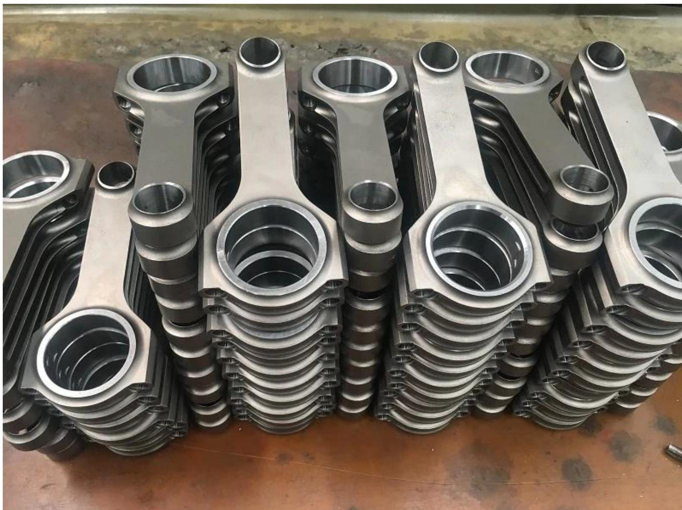
Hurricane también ha fabricado un diseño de viga I para la aplicación Nissan QR turbo, la biela de la viga I es extremadamente liviana que la H bean y está diseñada para todas las aplicaciones NA y de bajo impulso.
